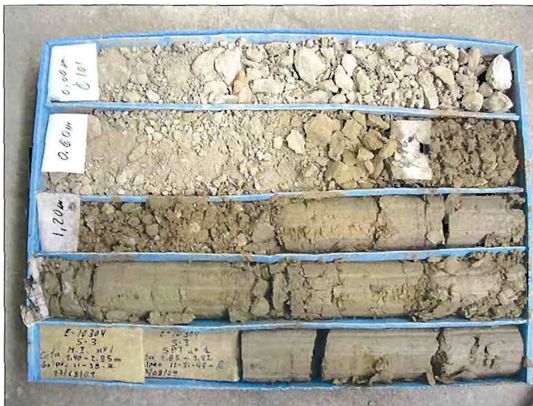
Caja del sondeo S3 de 0,00 a 3,80 metros de profundidad
