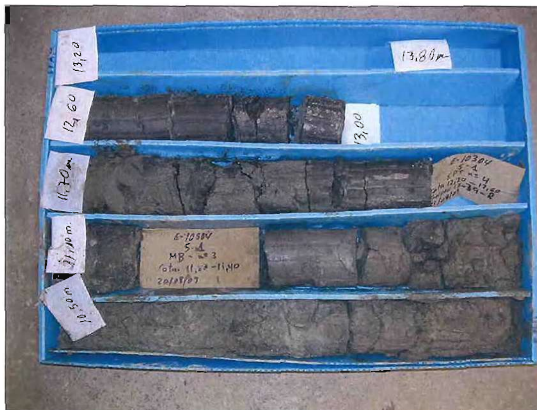
Caja del sondeo S1 de 10,50 a 13,80 metros de profundidad
