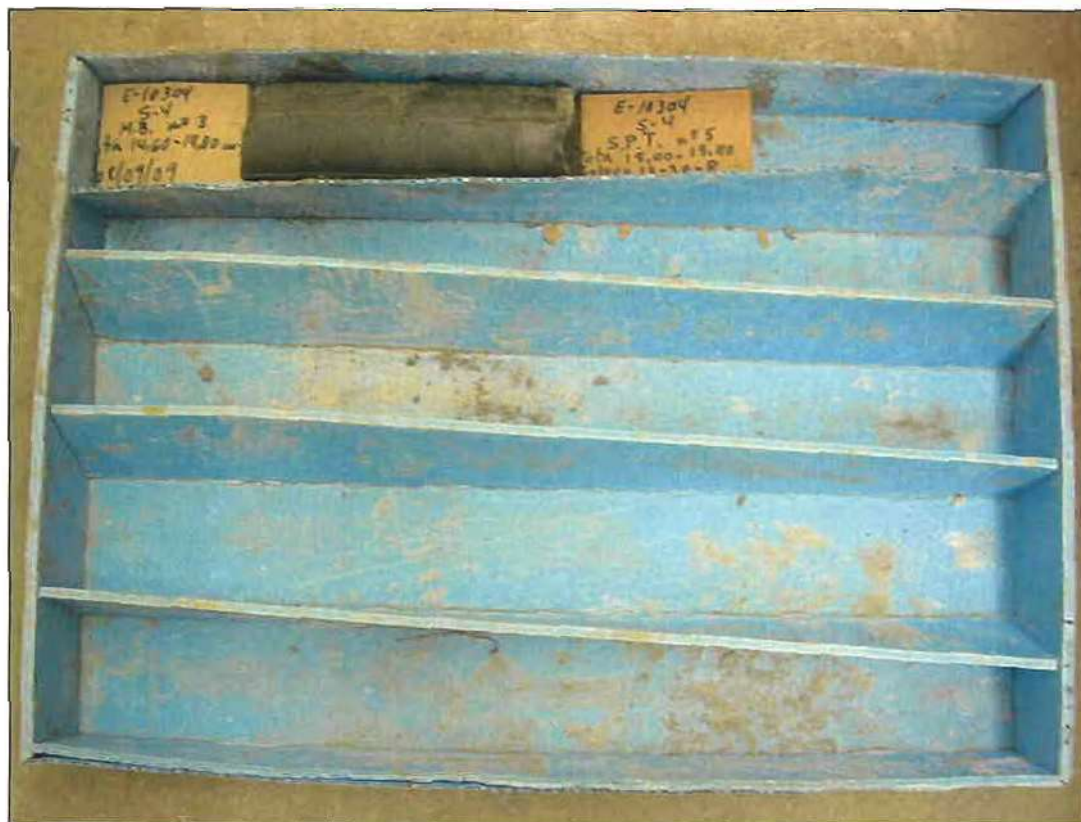
Caja del sondeo S4 de 14,60 a 15,40 metros de profundidad
