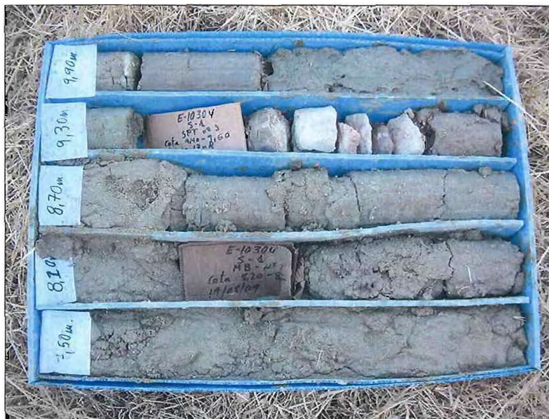
Caja del sondeo S1 de 7,50 a 10,50 metros de profundidad
