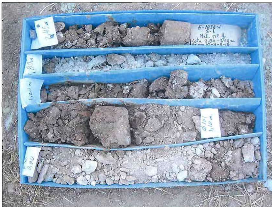
Caja del sondeo S1 de 0,00 a 3,40 metros de profundidad
