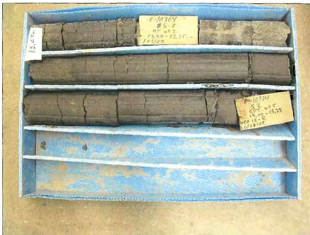
Caja del sondeo S2 de 13,25 a 15,28 metros de profundidad
