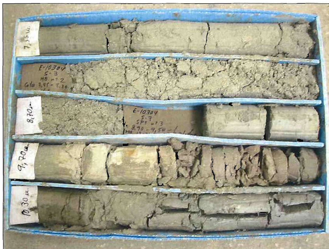
Caja del sondeo S3 de 7,55 a 10,90 metros de profundidad
