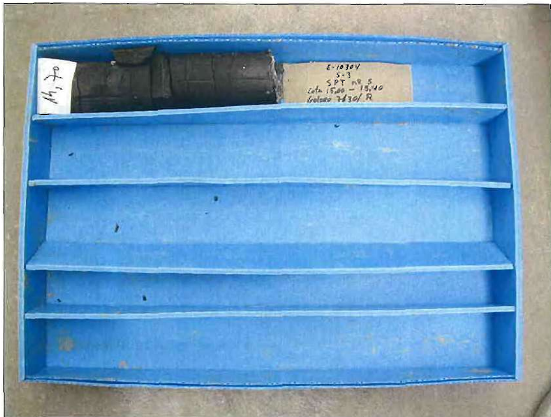
Caja del sondeo S3 de 14,70 a 15,40 metros de profundidad
