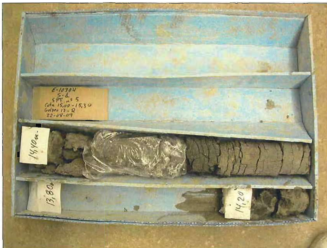
Caja del sondeo S1 de 13,80 a 15,30 metros de profundidad
