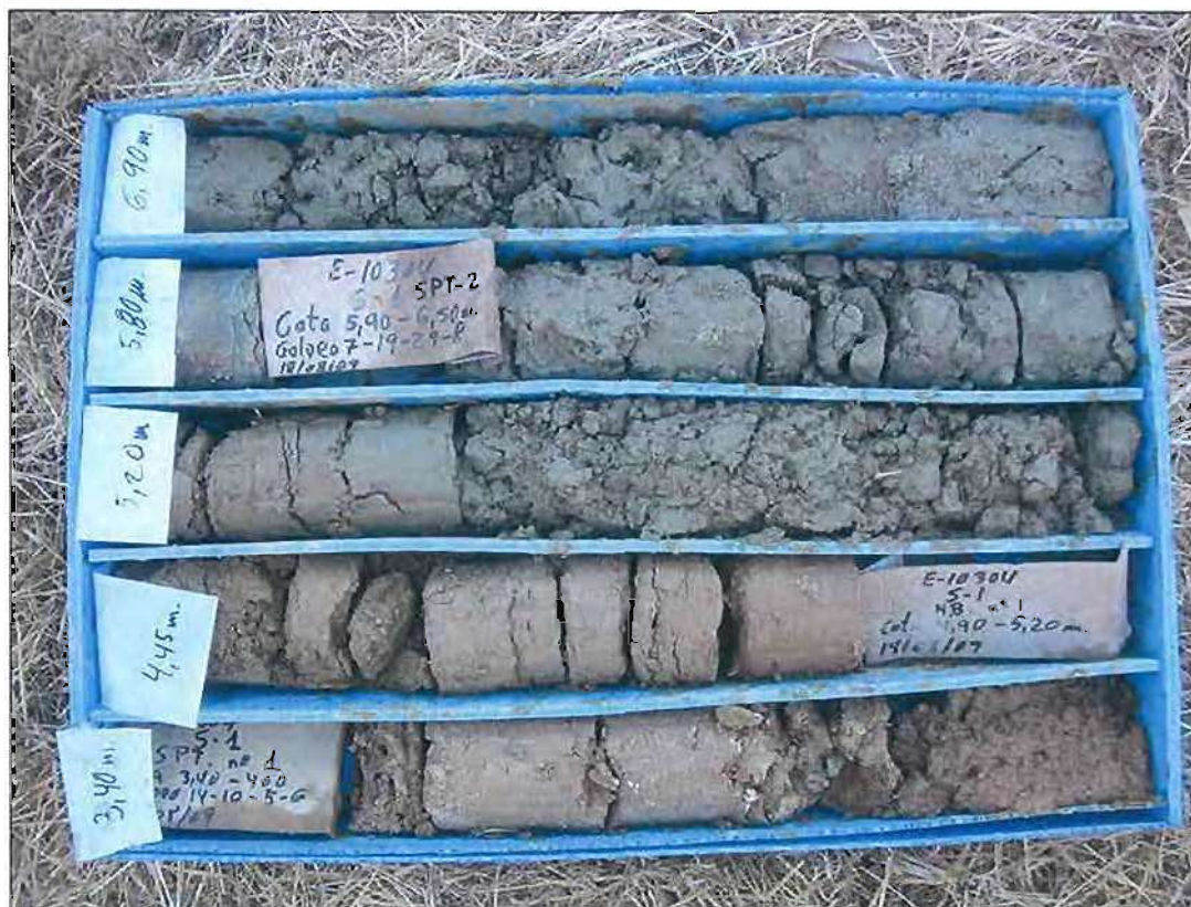
Caja del sondeo S1 de 3,40 a 7,50 metros de profundidad
