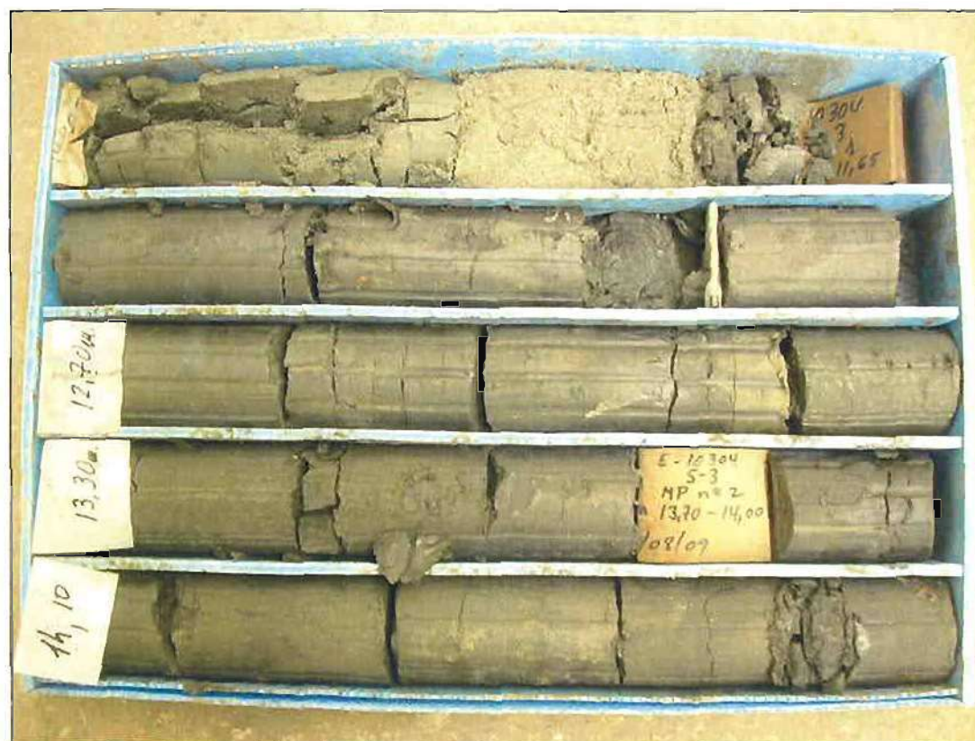
Caja del sondeo S3 de 10,90 a 14,70 metros de profundidad
