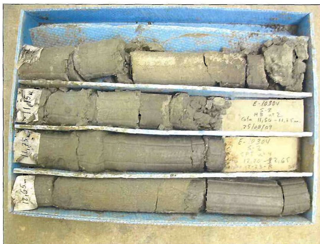
Caja del sondeo S2 de 10,50 a 13,25 metros de profundidad
