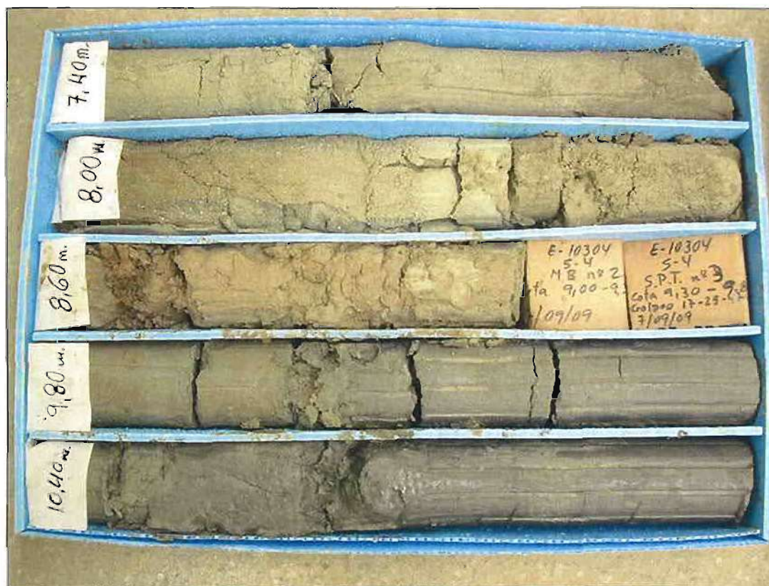
Caja del sondeo S4 de 7,40 a 11,00 metros de profundidad
