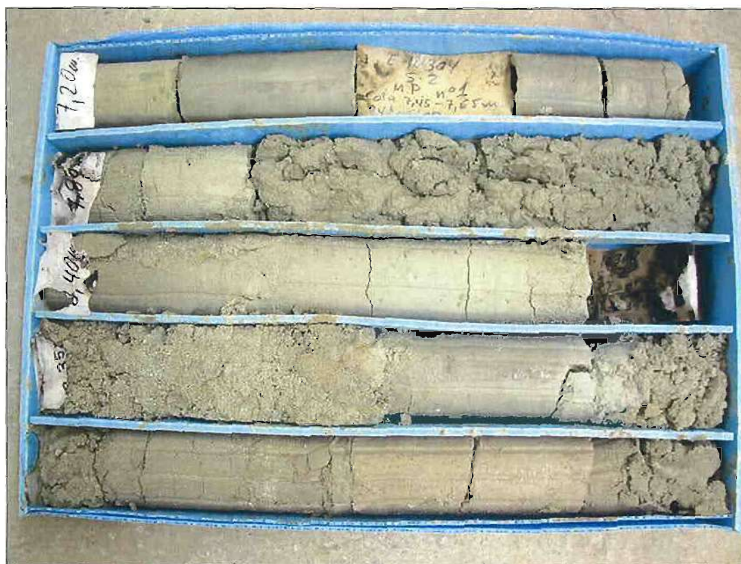
Caja del sondeo S2 de 7,20 a 10,50 metros de profundidad
