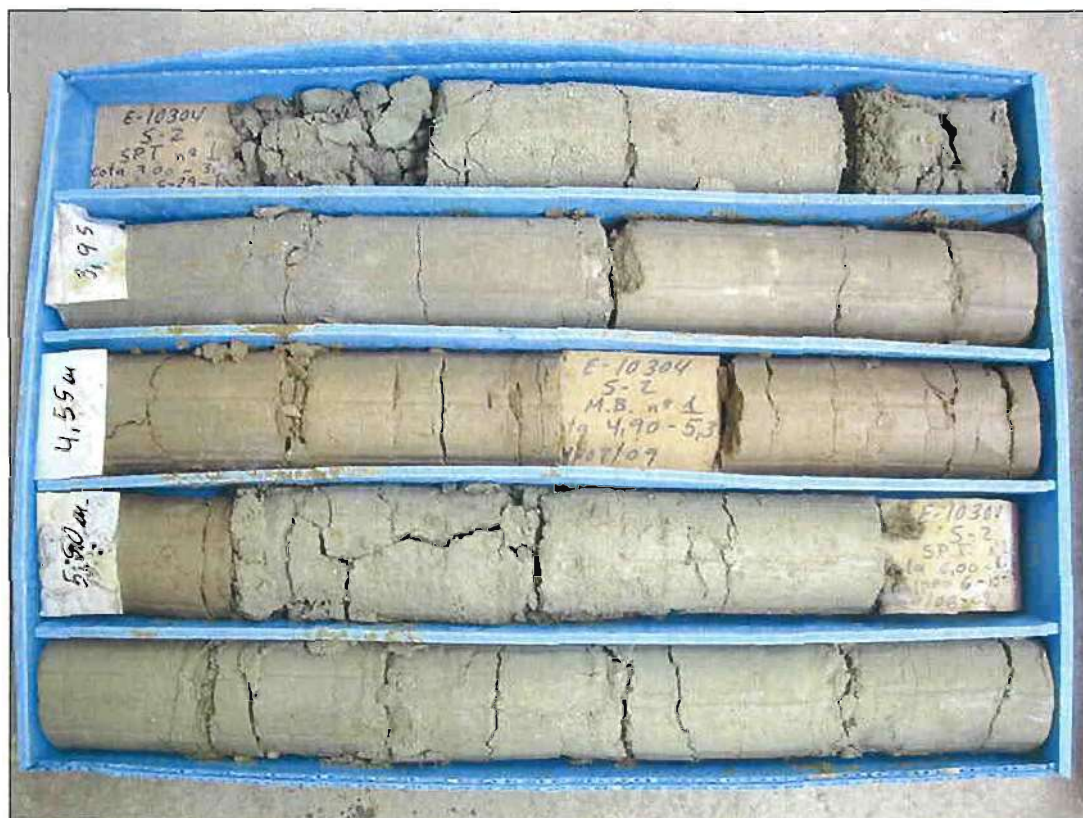
Caja del sondeo S2 de 3,00 a 7,20 metros de profundidad
