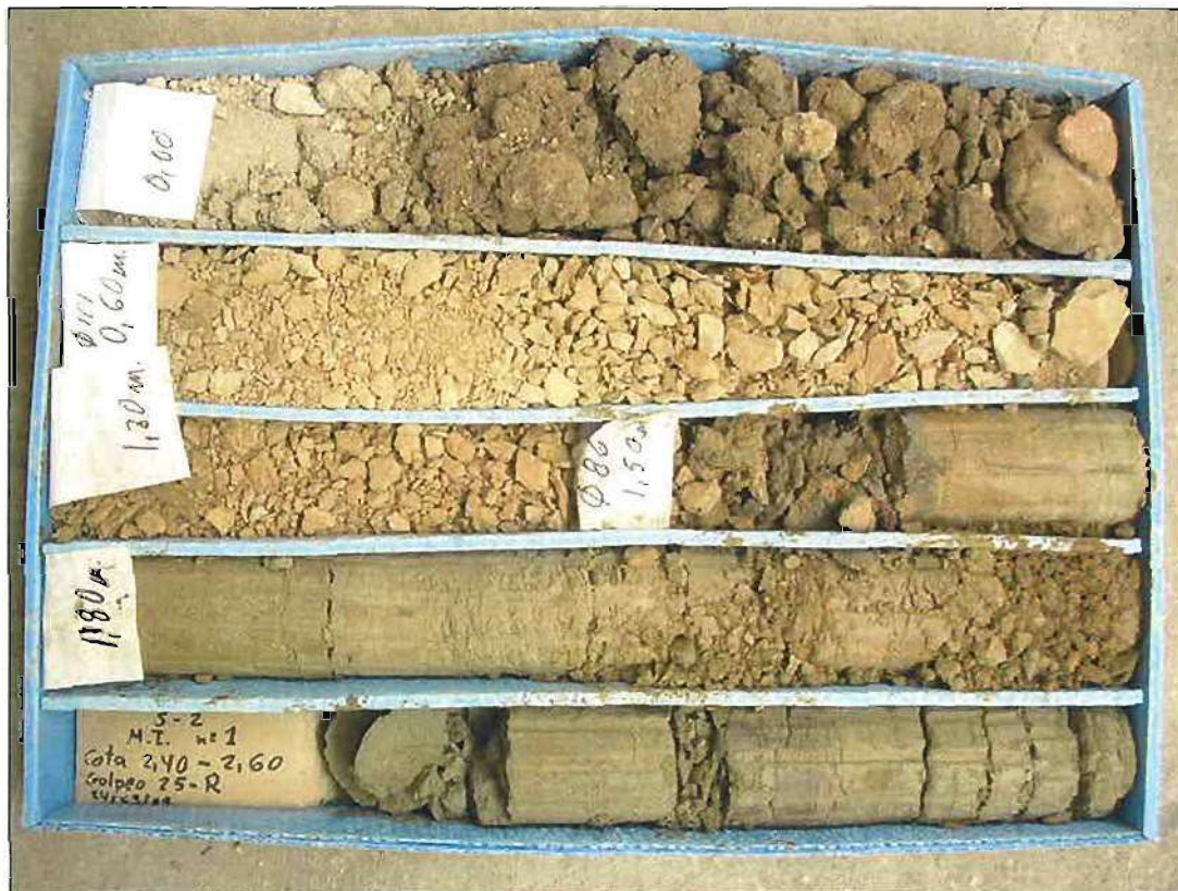
Caja del sondeo S2 de 0,00 a 3,00 metros de profundidad
