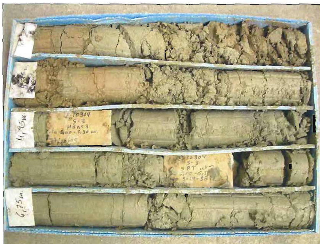
Caja del sondeo S3 de 3,80 a 7,55 metros de profundidad
